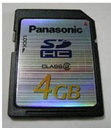
SDHCカードは以前のSDカード(2G迄)の後継機種で、32Gまでの大容量製品が出ている。SDHCカード対応のデジカメやカードリーダーで操作できる。
